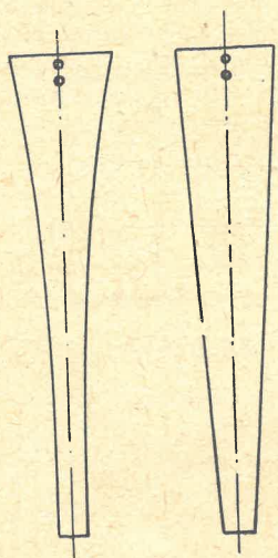
Obr. 29. Tvarové sondy pro ovládání čerpadel.
