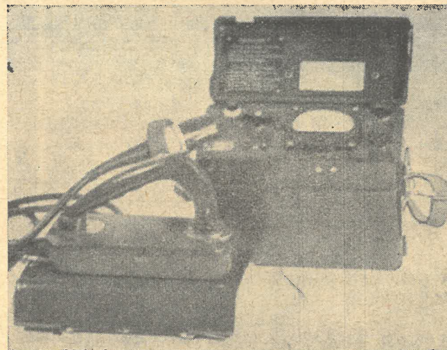
Obr. 23. Radiometr PGR pro měření \beta záření
