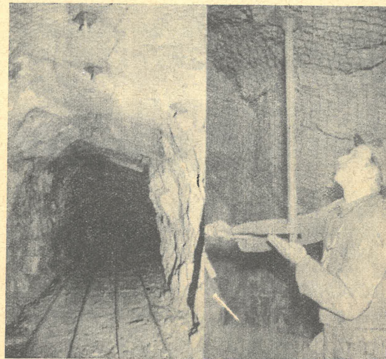
Obr. 13. Překop se svorníkovou výztuží s drátěným pletivem (vlevo) a utahování matice šroubu (vpravo) — důl Eliáš, Jáchymov.
