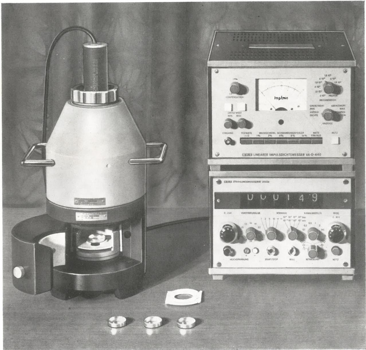
Für die Erweiterung zu einem Spektrometer mit analoger oder digitaler Meßwertausgabe besitzt das Strahlungsmeßgerät 20 026 Anschlußmöglichkeiten für einen Impulsdichtemesser VA-D-440, eine Spektrometereautomatik VA-G-130, einen Ergebnisdrucker 23 144 sowie für einen Schreiber VA-G-140 unserer Produktion.
