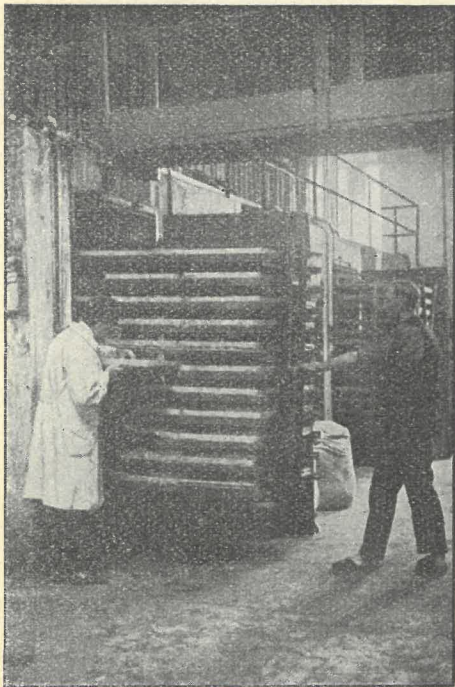
Sušení radioaktivních substancí.
